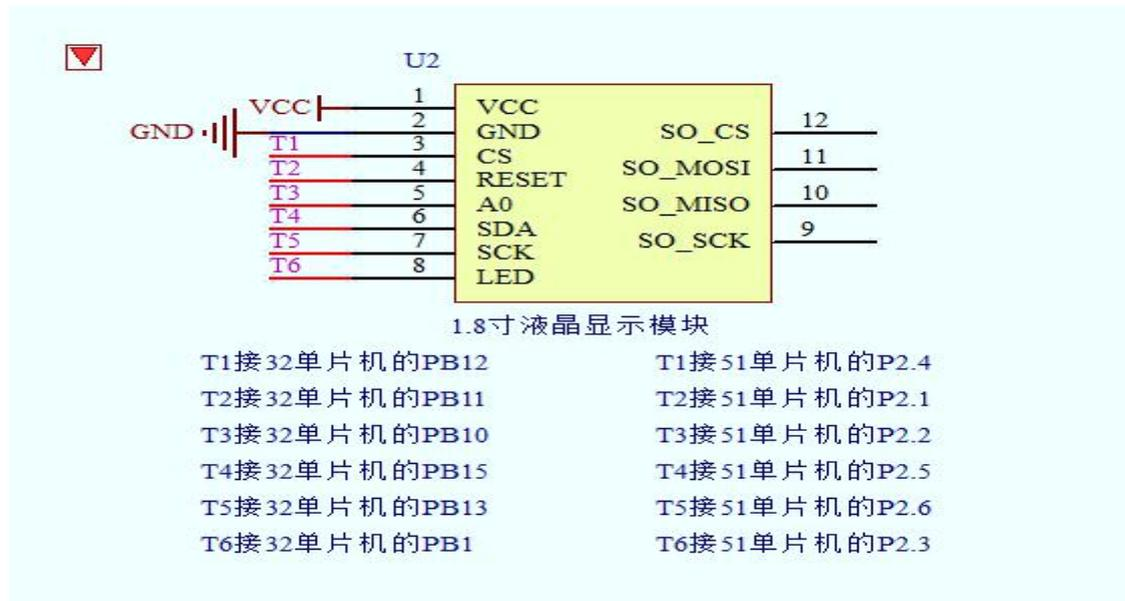
(3) 单片机管脚链接表：详见收到的 AD 工程中的 Device For Display 中的 1.8 寸液晶显示模块原理图。
