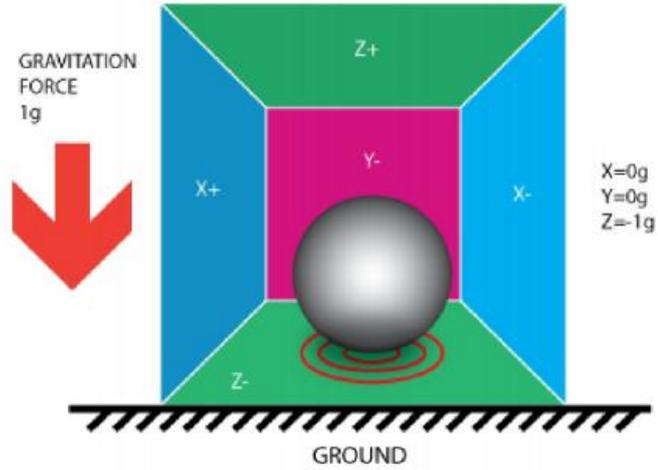
在这种情况下, 框不动, 但我们仍然可以得到Z轴的读数-1G。球在墙壁上的压力造成的引力场。
