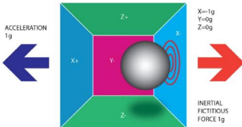
请注意,加速度计反应的加速向量与当前的受力方向是相反的.如上图所示,受力方向向左,但是加速度的向量方向为右.
