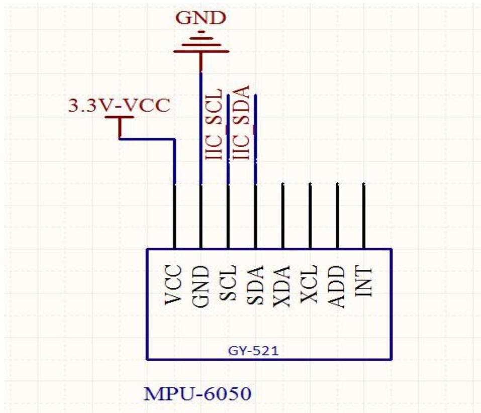
(3) 单片机管脚链接表：详见收到的 AD 工程中的 Device For SensorModular 中的 MPU-6050 模块原理图。
