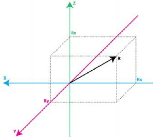
请看一下上面的模型, 这是一个新的模型代替刚刚的盒子立方体。试想一下, 在新模型中的每个轴是垂直于盒子的壁面。向量R是加速度计测量 (从上面的例子或这两者的组合, 它可以是引力场或惯性力) 的力矢量。接收时,  $R_y, R_z$ 与上的X, Y, Z轴的R矢量投影。请注意下面的关系式:
